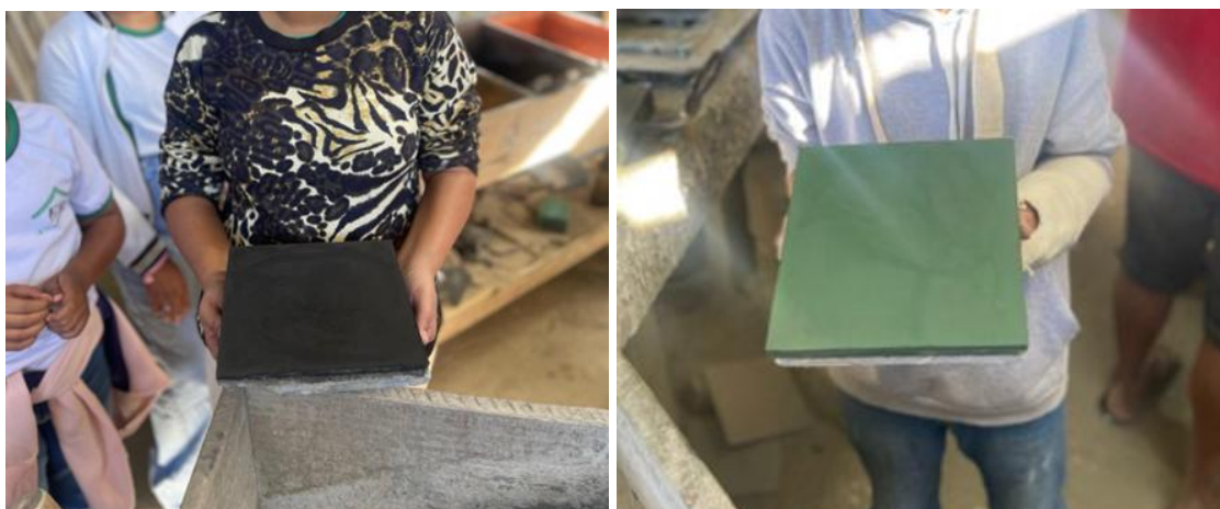
Imagem 6 e 7 - Ladrilhos hidráulicos produzidos pelos alunos com a supervisão dos trabalhadores da fábrica. Fonte: Arquivo pessoal dos autores.
